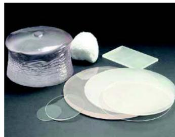
Des disques de saphir tirés d'un bloc de cristal artificiel (à gauche).
